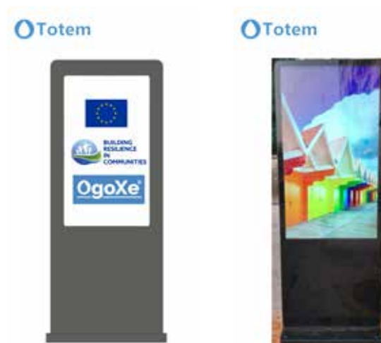
(A) prototype de conception de l'écran Ogoxe Totem ; (B) photo de l'écran Ogoxe Totem. Notez que le totem semble mouillé, car la photo a été prise dans des conditions d'essai, alors que de l'eau avait été versée directement dessus afin de tester son étanchéité.
